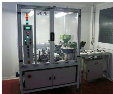
Machine spéciale d'assemblage de rubans pour le contrôle de l'hygrométrie de l'air
