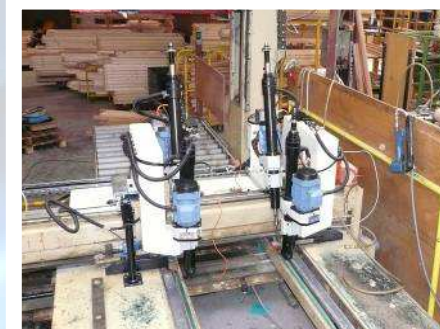
Intégration d'unités de perçage automatisées pour la réalisation des trous d'évacuation d'eau dans les encadrements de fenêtre
