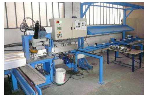
Machine de perçage de poutrelles de coffrage de dalles pour le bâtiment
